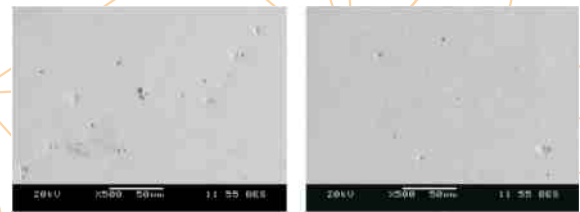
Рис. 4. Неметаллические включения в образцах стали 20: а – через 3 мин; б – через 12 мин после ввода модификатора
