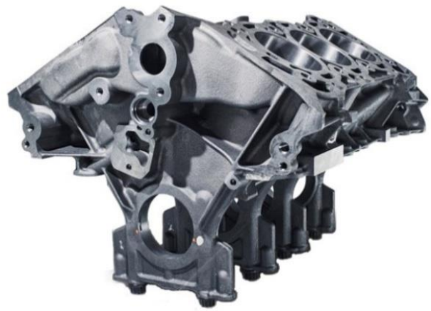
Рис. 3. БЦ 2.7 литрового V6 бензинового двигателя Ford с опорами коренных подшипников, изготовленными по разрывной технологии (~50 кг, ЧВГ 400, благодарность: Ford Motor Company)
