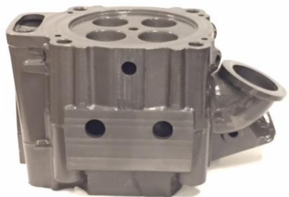
Рис. 7. ГБЦ тепловозного двигателя General Electric (~175 кг, благодарность: General Electric)
