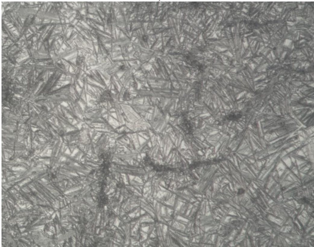
Рисунок 2. Микроструктура ЧВГ режим 1, Б+М с остат. А, \times 500 , травлено
